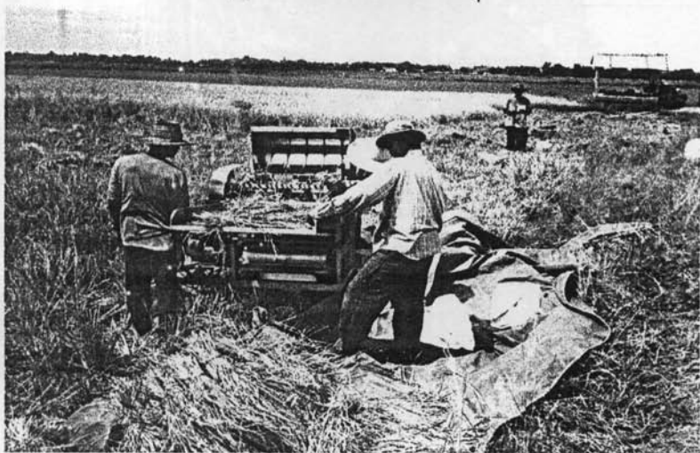
เครื่องนวดเล็กใช้นวดข้าวที่เก็บไว้ทำพันธุ์
